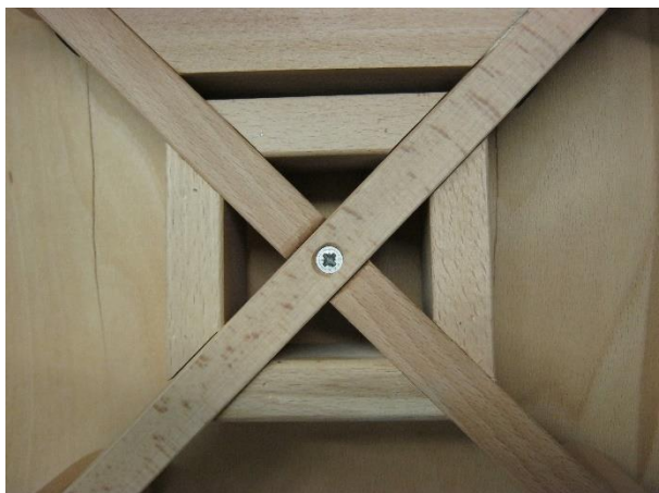
Foto 5: Proefstuk 180225-2 – hoge kruk Beech Boy-4PT – detail onderaanzicht bevestiging zitting
